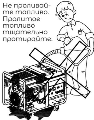
Не проливайте топливо. Пролитое топливо тщательно протирайте.
