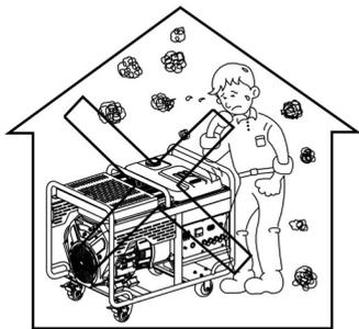
При использовании под открытым небом не запускайте электростанцию во время дождя или снега и при большой влажности.
