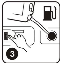
4. Поверните топливный переключатель в положение ON и дайте топливу попасть в карбюратор.
