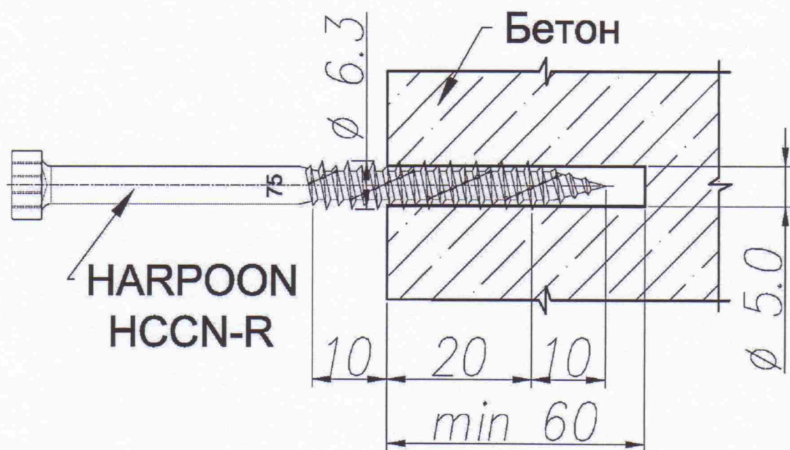
Рисунок 1 – схема установки винта.
