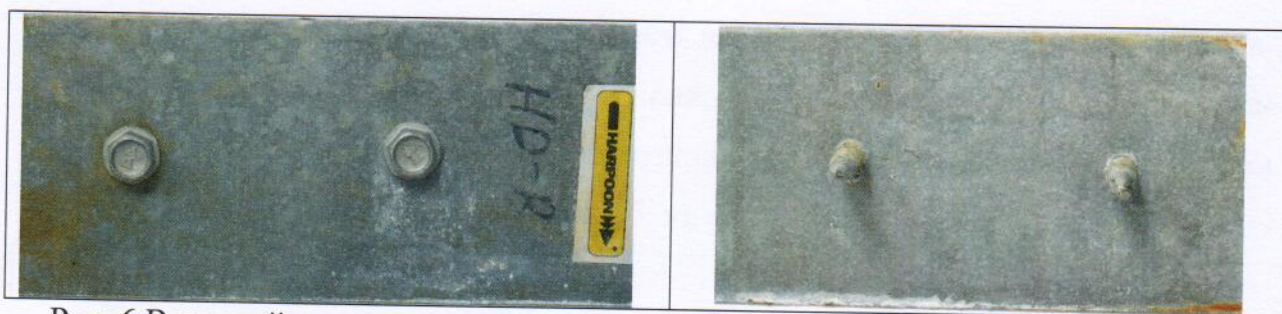
Рис. 6 Внешний вид винтов с покрытием RUSPERT TYPE II (образец №4) после испытаний в камере сернистого газа в течение 720 ч
