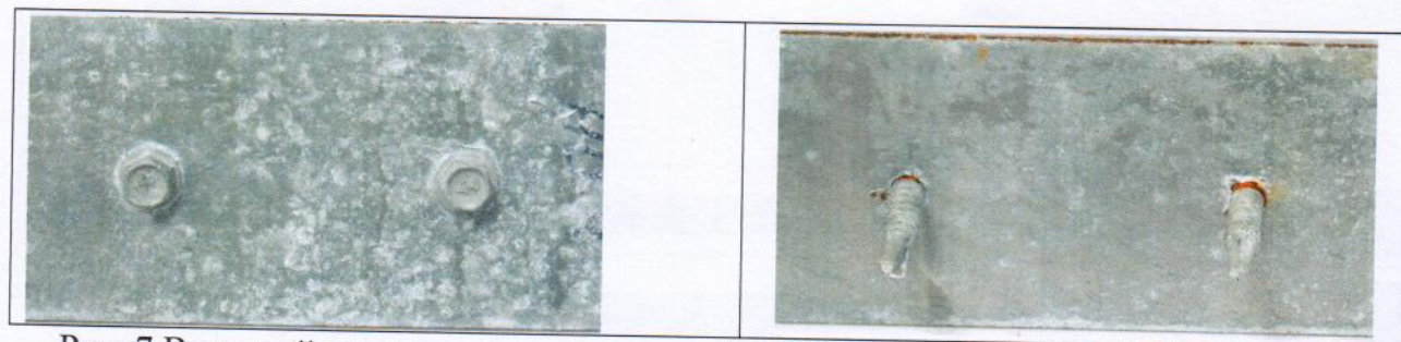
Рис. 7 Внешний вид винтов с покрытием RUSPERT TYPE II (образец №4) после испытаний в камере соляного тумана в течение 720 ч
