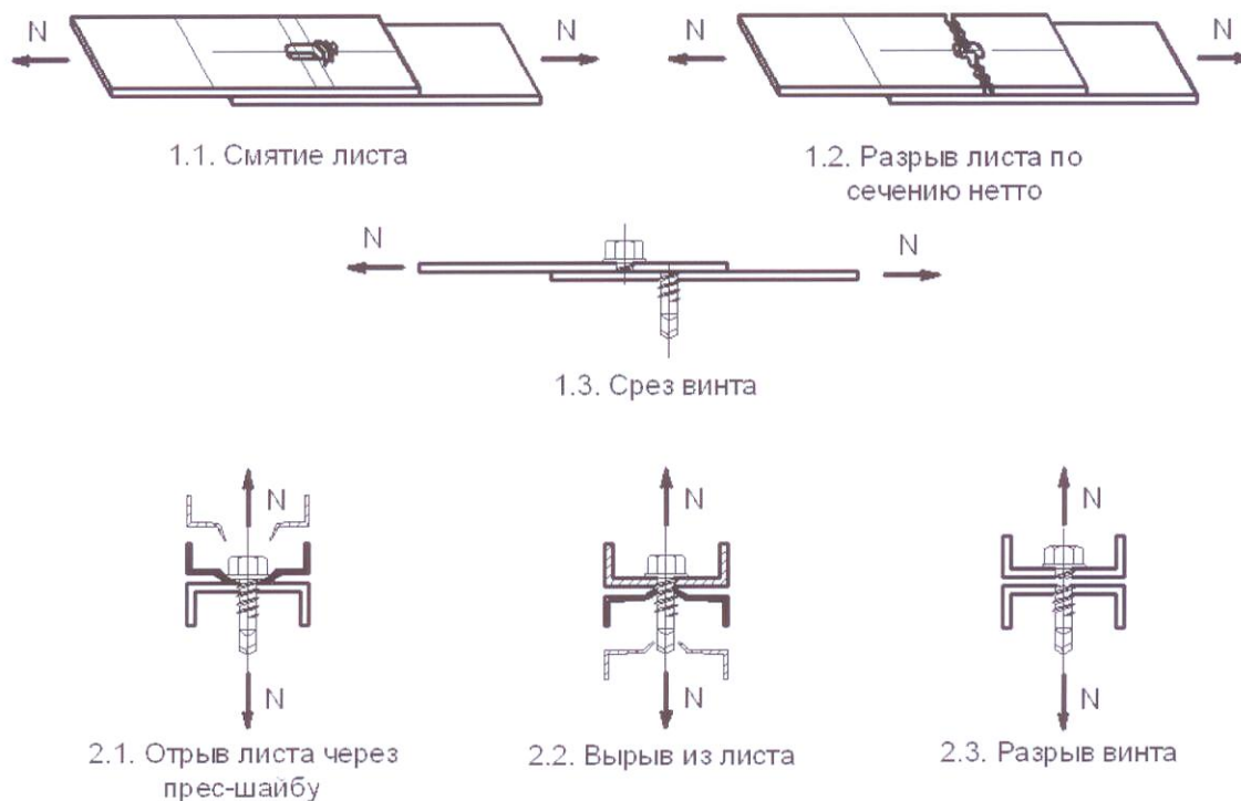
Рисунок 2. Типы отказов винтовых соединений.
